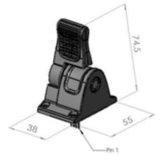
Pin1: +5V Pin2: GND
