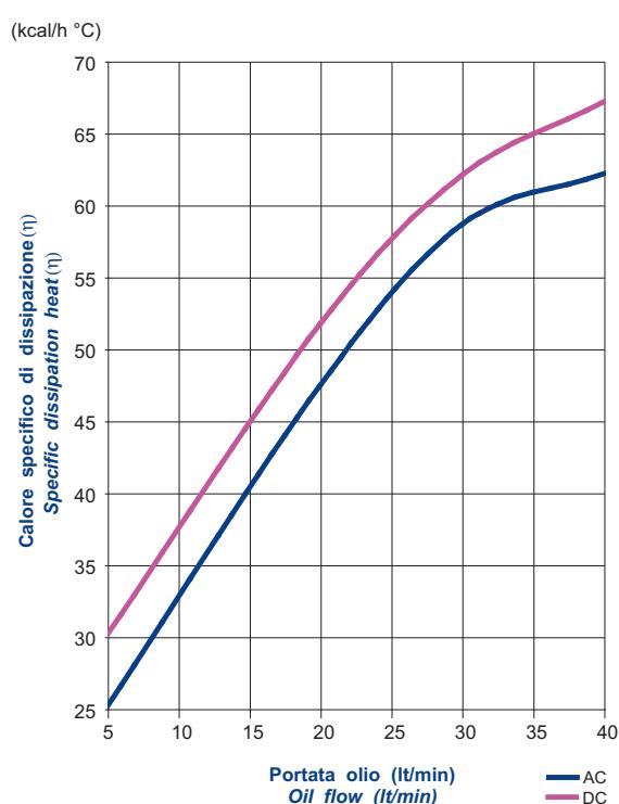
**CARATTERISTICHE TECNICHE DEL GRUPPO DI VENTILAZIONE**
